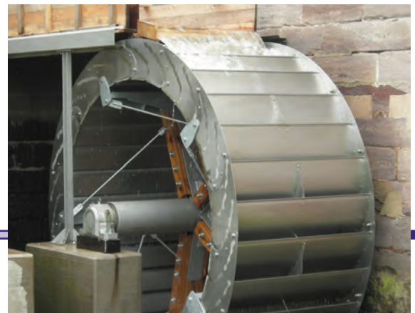
Wasserrad in Bendeleben, Neubau, 6 kW
